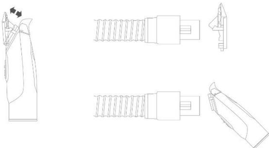
Pred inštaláciou noža zatahnite pohyblivý gombík pre nastavenie noža dole. Odsajte nečistoty z čepele a zastríhávača.
