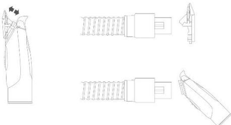
Przed zamontowaniem noża pociągnij w dół ruchome pokrętko regulacji noża. Odkurzyc brud z ostrza i trymera.
